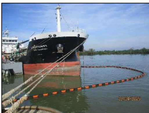
ภาพถ่ายที่ 2.2-5 การควบคุมการรั่วไหลของน้ำมัน ระหว่างการขนถ่าย
